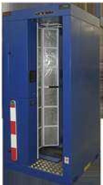
Предназначен для обнаружения радиоактивного загрязнения частей тела и одежды. В случае, если загрязнение превышает контрольный уровень выдается звуковой сигнал, происходит индикация местоположения загрязнения и отображается величина загрязнения.
